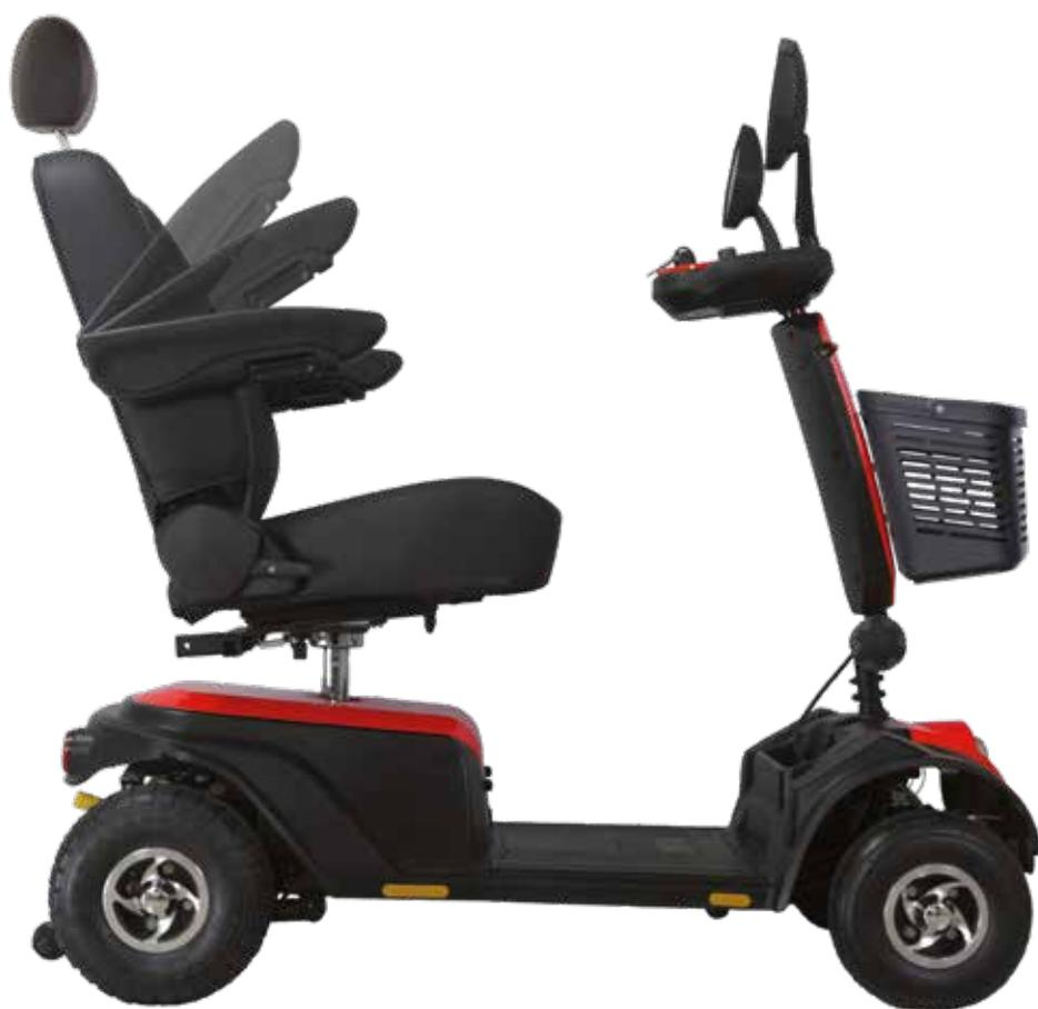
Scooter elettrico a 4 ruote con 4 ammortizzatori. Il telaio di medie dimensioni lo rende adatto ad un utilizzo in ambienti esterni e all'occorrenza anche all'interno.
