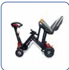
Sulla consolle del manubrio si trovano: uno schermo LED, pulsanti e leve, per attivare e visionare le diverse funzionalità dello scooter e l'indicatore di carica della batteria. Il telaio in lega di magnesio, dal peso molto contenuto e completamente pieghevole senza l'utilizzo di attrezzi, lo rende facilmente trasportabile.
