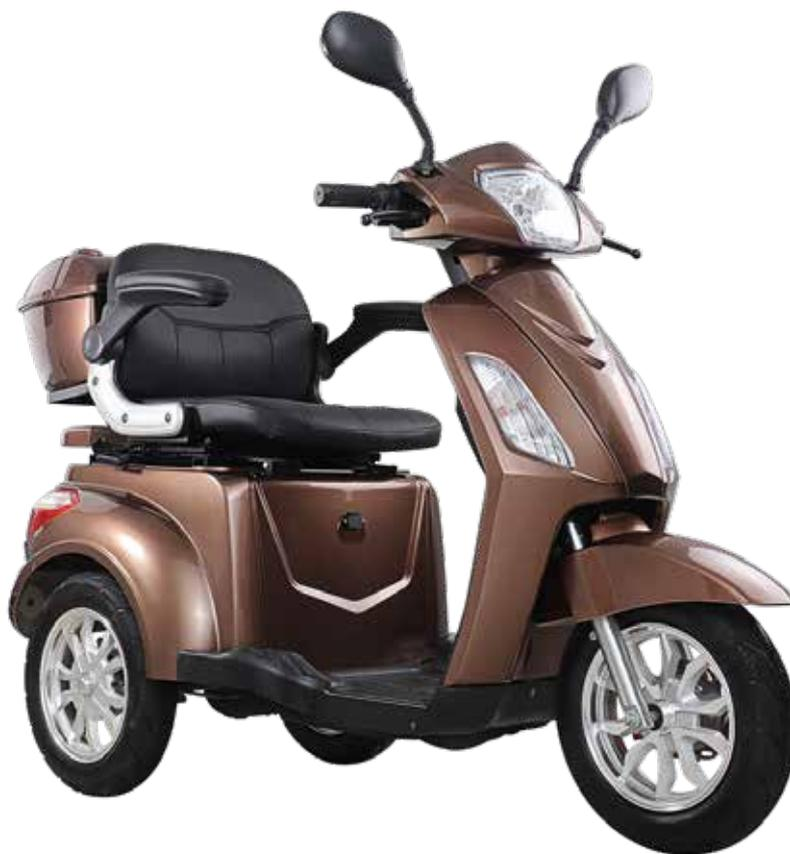
ENDURANCE scooter elettrico con 3 ruote pneumatiche su cerchi in lega da 15", dotato di ammortizzatori anteriori e posteriori. Il telaio di grandi dimensioni, ma di facile manovrabilità, lo rende adatto ad un utilizzo in ambienti esterni e per lunghe percorrenze.
