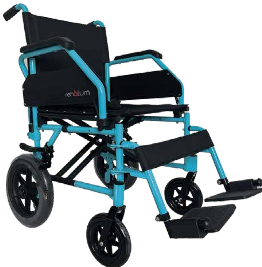
Carrozzina con telaio in alluminio, pieghevole a doppia crociera predisposto in configurazione standard con ruote posteriori ad estrazione rapida da 12" con copertone in PU pieno con predisposizione, in alternativa, di attacco per ruote posteriori da 24" ad estrazione rapida con copertone in PU pieno. Braccioli semi-desk ribaltabili, pedane estraibili e regolabili in altezza.
