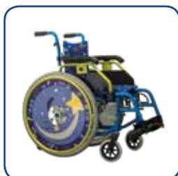
Carrozzina con telaio pieghevole in alluminio, ruote posteriori 22" con copertoni pieni in PU ad estrazione rapida e possibilità di posizionamento variabile, dotate di mancorrenti in alluminio, freni di stazionamento, kit antiribaltamento. Le ruote anteriori hanno dimensione 6" montate su forcella in alluminio con possibilità di regolazione su tre posizioni per variare l'altezza della seduta.
