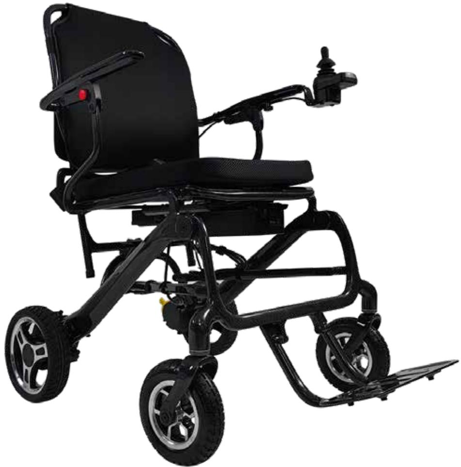
Carrozzina elettrica con telaio in carbonio pieghevole a portafoglio, schienale con rivestimento in Nylon imbottito, con tasca posteriore.
