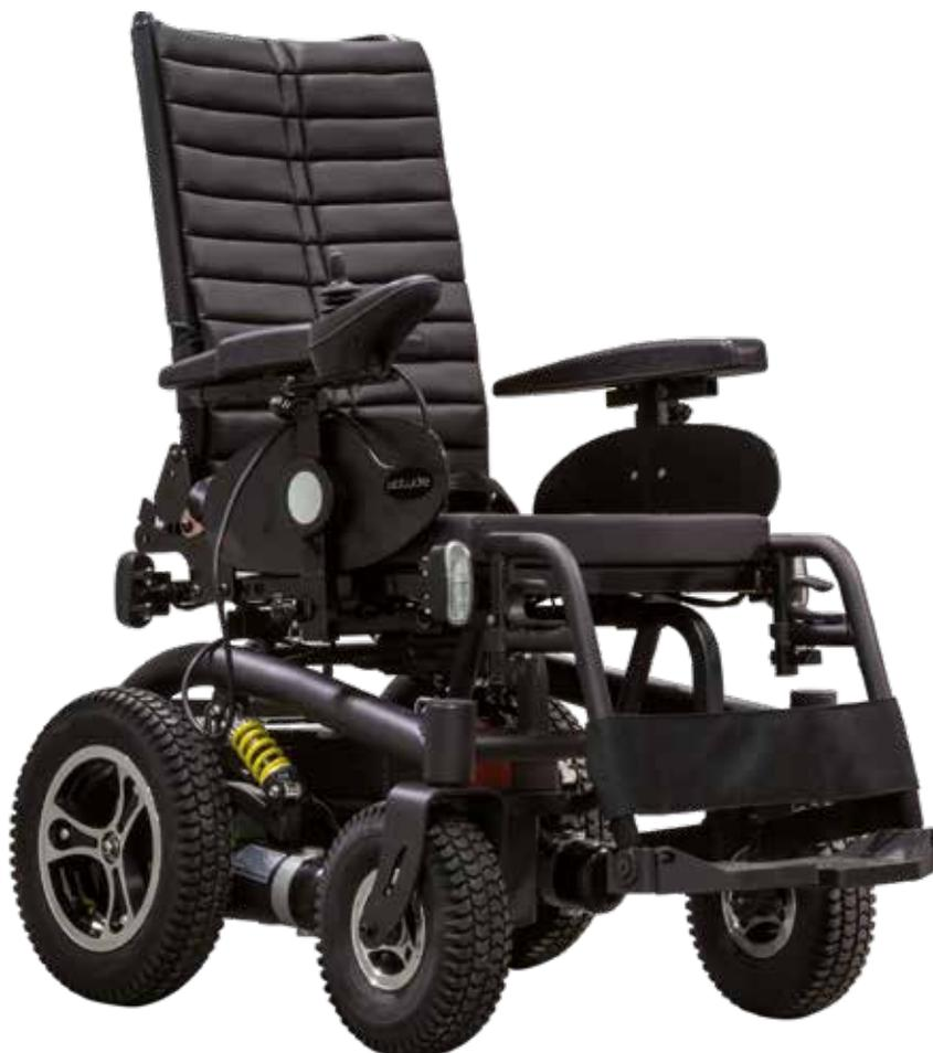
Carrozzina elettrica da esterni con ammortizzatori posteriori e telaio riducibile per agevolare il trasporto.
