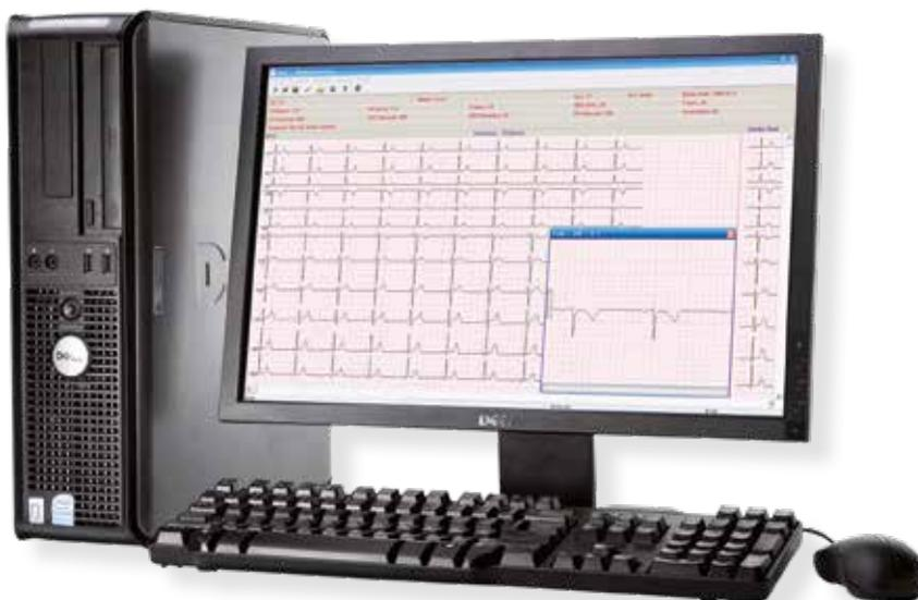
Software per sistemi operativi Microsoft Windows per trasferire gli esami ECG dagli strumenti Biocare al personal computer, mediante connessioni seriale, USB e LAN.
