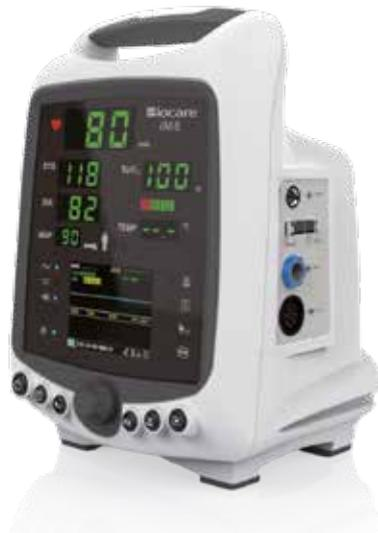
Monitor multiparametrico iM8 per la visualizzazione e controllo di parametri vitali del paziente quali la pressione arteriosa non invasiva, la saturazione di ossigeno e la temperatura.
