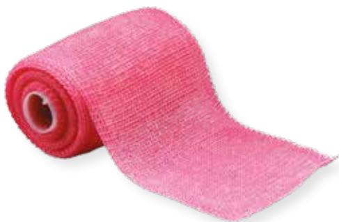
3M Scotchcast Plus è una benda sintetica in fibra di vetro contenente una resina poliuretanica e un catalizzatore aminico che a contatto con l'acqua o semplicemente esposta all'umidità dell'aria si indurisce, consentendo la realizzazione di apparecchi per immobilizzazione estremamente leggeri e resistenti.
