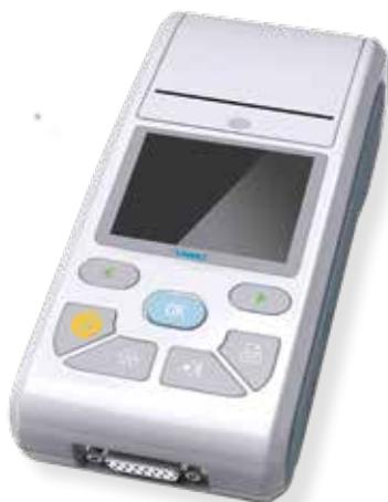
Strumento portatile palmare per l'acquisizione e la stampa del tracciato elettrocardiografico a 12 derivazioni con interpretazione e misurazioni. Dotato di un display LCD a colori touch-screen da 2,8" e di una piccola tastiera intuitiva per la gestione dell'esame ECG.
